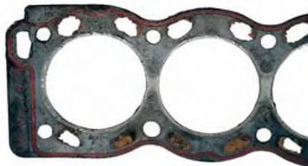
Zdj. 2: zniszczona uszczelka podgłowicowa z materiału miękkiego
